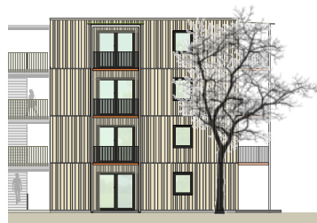
Ausführung mit hinterlüfteter Naturholzfassade, die Wärmedämmung besteht aus Holzweichfaserplatten.
