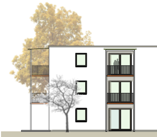
Ausführung mit Putzfassade.
